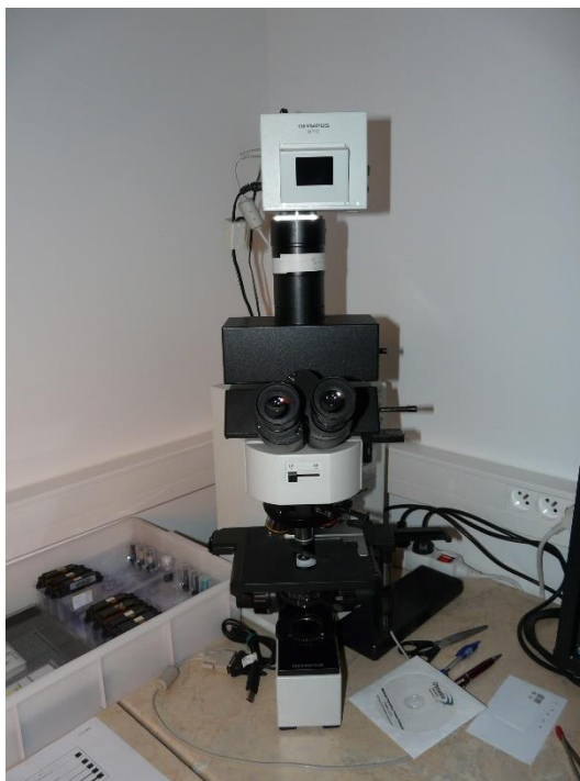
Obrázek 5.1: Pracoviště s mikroskopem Olympus BX60 s kamerou DP 10 použité pro optickou kontrolu vyrobených vzorků.
